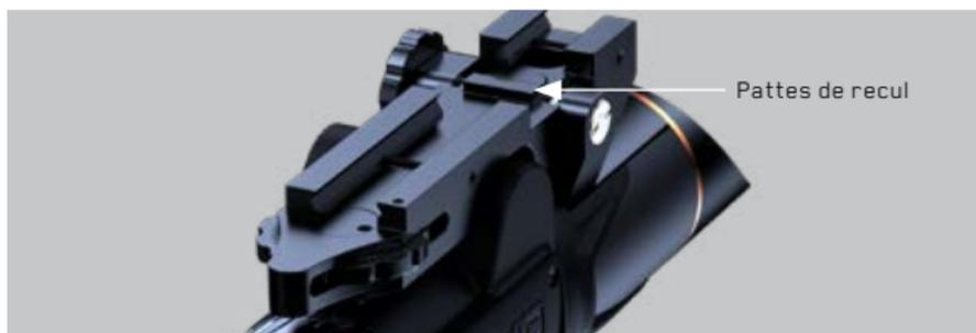
Avec les écrous de serrage desserrés, poussez la portée vers l'avant jusqu'à ce qu'il y ait un contact métal-métal ferme sur la patte de recul. Serrez les deux boulons à 40 à 70 po.
