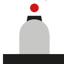
Проекция лазера на расстоянии ок. 5 м При выровненном прицеле лазерная точка видна прямо над мушкой.
