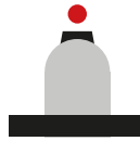
Projektion des Lasers in ca. 5m Entfernung. Der Laserpunkt ist bei ausgerichtetem Visier knapp über dem Korn zu sehen.
