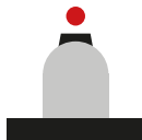
Proyección del láser a una distancia aprox. de 5 m. Con el visor orientado, el punto láser se aprecia justo encima del punto de mira.
