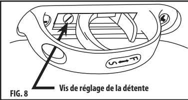
FIG. 8 Vis de réglage de la détente
