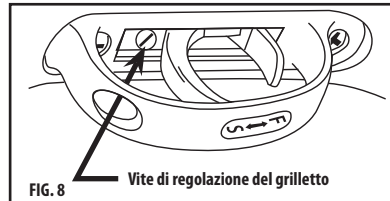
FIG. 8 Vite di regolazione del grilletto
